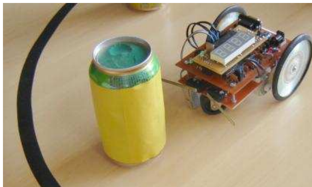
Figura 8. Robô localizando uma lata para empurrá-la até a linha
