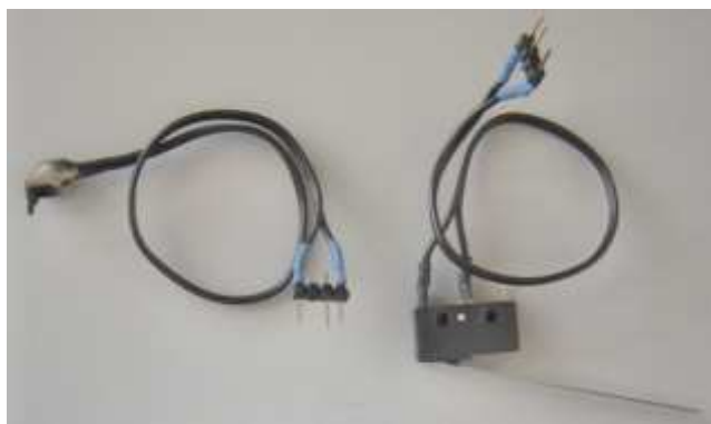
Figura 2. Sensores de toque utilizando micro chaves
