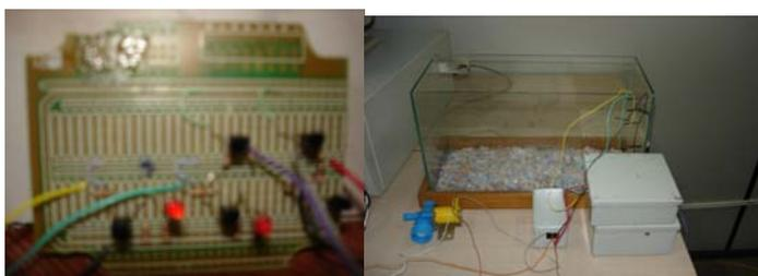
Figura 5. Circuito de controle e Protótipo do IPA em funcionamento
