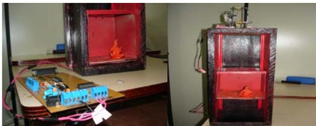
Figura 3. Elevador construído com material de sucata.
