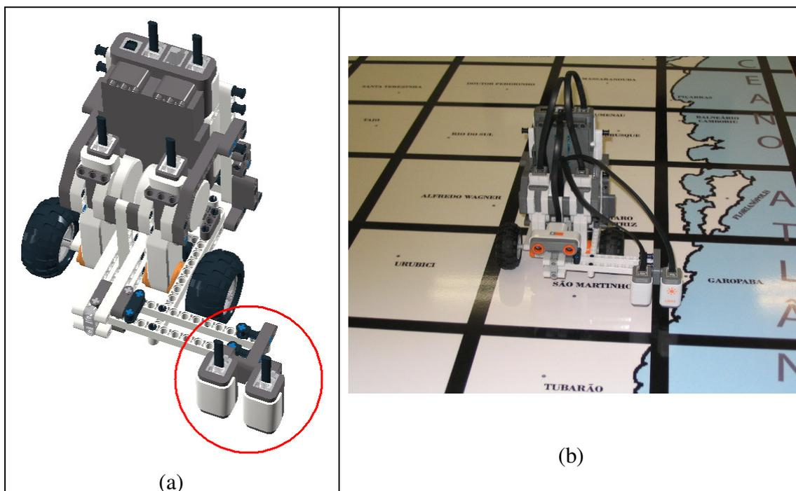
**Figura 4. Robôs do projeto. (a) em destaque os sensores para alinhamento do robô; (b) um robô inserido no mundo real**
