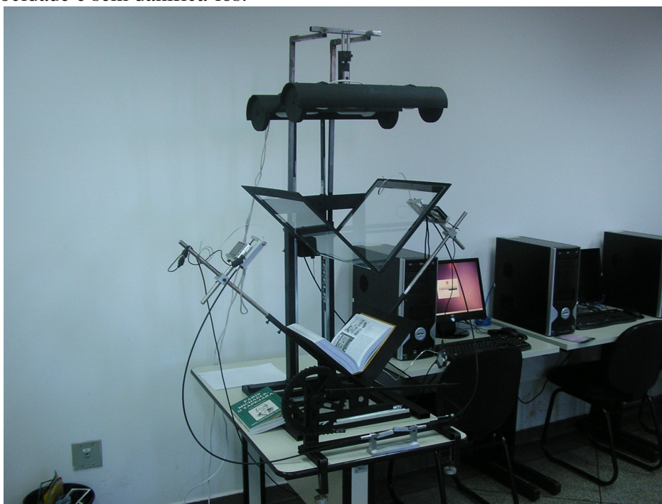
Figura 1: scanner documental desenvolvido pela equipe de pesquisa.
