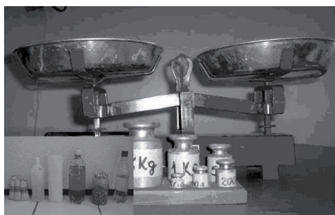
Figura 2 – Balança de dois pratos
