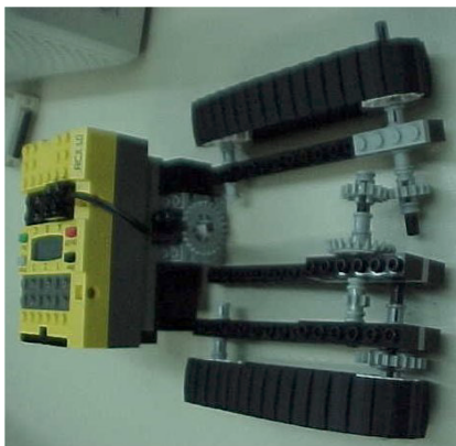
Figura 5 – Robô Afrodite com sistema de deslocamento baseado em esteiras
