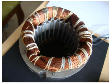
Figura 2 - Estator do motor em que foi realizado o experimento junto com o marcador
