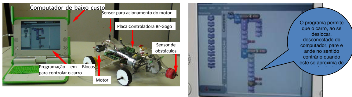
Figura 5. Carro construído com garrafa pet e rodas de isopor
