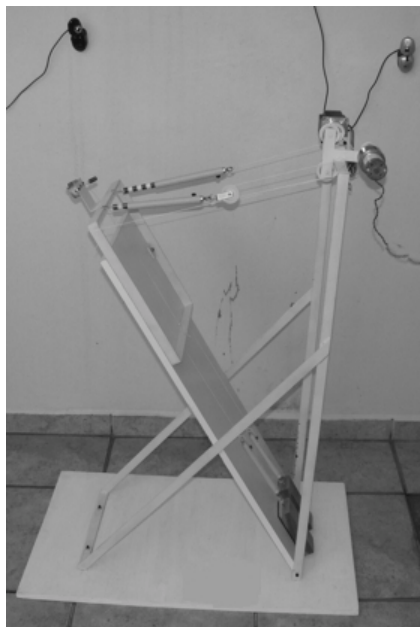
Figura 3(a) Plano inclinado automatizado perfil
