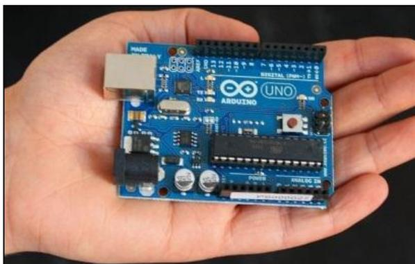
**Figura 1.1: Placa eletrônica Arduino**
